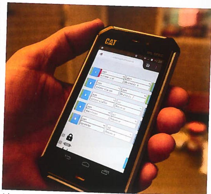
Adams kan de klimaatapparatuur via FarmConnect van zijn leverancier via de telefoon bedienen. Alarmmeldingen gaan naar drie telefoons.
